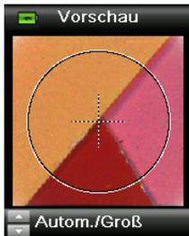
Die zuerst angezeigte Farbe im Fenster Treffer ist das Mittel aus allen Farben im Messbereich. Wenn CAPSURE eine Probe erkennt, die aus mehreren Farben besteht, dann dreht sich das Symbol Farbauswahl in der Funktionsleiste und es erklingt ein Signalton. Die Anzeige wechselt automatisch zur Farbauswahl. Hier können Sie die einzelnen Farben der Messung auswählen.
