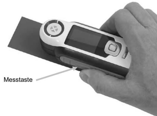
Bei der Messung ist es egal, wie Sie das Gerät halten. Bitte achten Sie jedoch darauf, dass das Gerät gut mit der Oberfläche abschließt.
